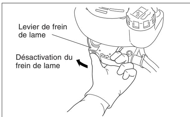
(Après le démarrage du moteur, désactiver le frein de lame avant de commencer à utiliser la machine.)
