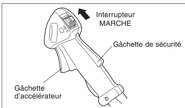
3. Placez l'interrupteur Marche/Arrêt en position "START".
